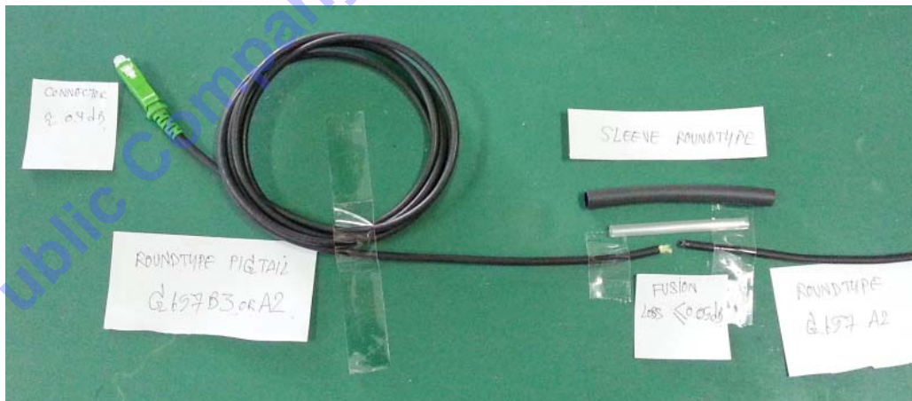
ภาพประกอบที่ 15. การต่อเชื่อมโยงเส้นใยแก้วนำแสงด้วยชุดอุปกรณ์ Pigtail Round Type 3.5 mm.
